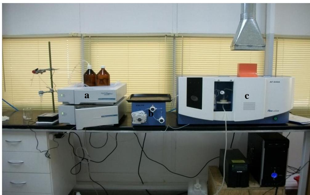
**Figura 2.5.3:** Sistema cromatográfico a) bomba cuaternaria con un sistema desgasificador, b) PDI-UV (sistema de digestión) y c) espectrómetro de fluorescencia atómica (AFS).
