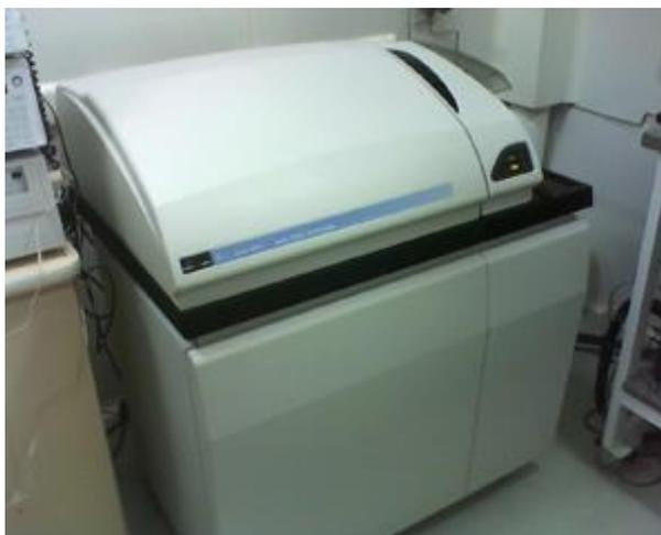
**Figura 2.5.2:** Espectrómetro de masas modelo Elan DRC-e ICP-MS de Perkin Elmer.
