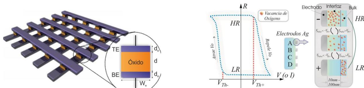
**Figura 1.** (Izq) Arreglo de juntas metal/óxido/metal que funciona como memoria RRAM. Permite una densidad 10 veces mayor que las memorias actuales. (Der) Respuesta de la R a la tensión aplicada, donde se ven dos estados de resistencia (lógica binaria) y esquema de movimiento de vacancias de oxígeno que da origen a la conmutación de la resistencia.
