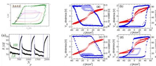
**Figura 7.** Se logró obtener 7 niveles de resistencia y apagar el comportamiento de las memorias basadas en  $PrCaMnO_3$ .
