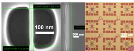
**Figura 5.** Miniaturización del transistor de efecto de campo hasta los 20 nm y de las estructuras MOM hasta los 40 nm. Se muestra también el correcto alineamiento geométrico entre diferentes estructuras y la unión de un transistor con una estructura MOM.
