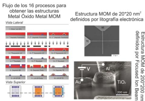
**Figura 4.** Flujo de procesos necesarios para construir una estructura MOM. En el centro se observan dispositivos micrométricos fabricados por PLD, *sputtering* y evaporación en combinación con litografía óptica. Finalmente en la derecha se observan dispositivos ultra miniaturizados por litografía electrónica y *focused ion beam*.
