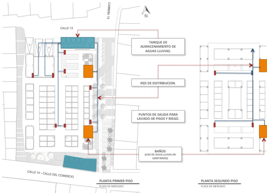
Figura 73. Esquema de distribución de agua lluvia recirculada.
