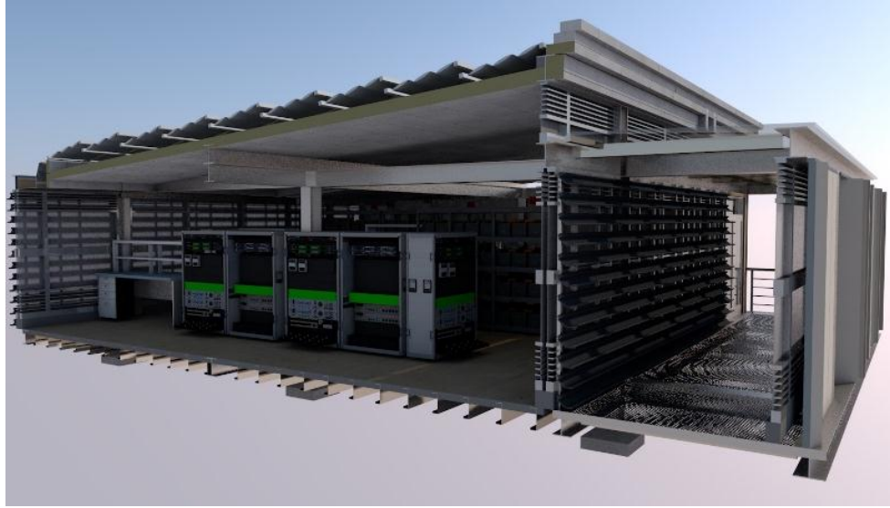
Figura 36. Sección trasversal corredor, cuarto técnico general
