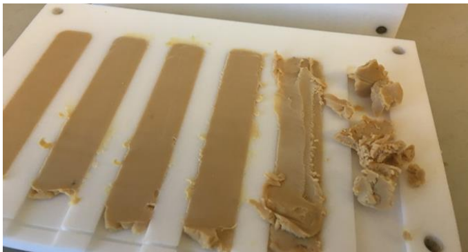
Abb. 63: Unvernetztes Siliconkomposit mit einem Füllstoffanteil von 25 wt% NPOSNP. Rechts gezeigt ist die sehr feste in Stücken überführte Probenmasse, daneben zu sehen ist die mittels Spatel und Rakel in die Form gepresste Masse sowie links das mittels Rakel glattgestrichene Komposit.
