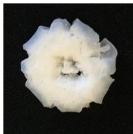
Abb. 66: Exemplarische Fotografie einer nach der Druckprüfung makroskopisch zerstörten bzw. permanent deformierten Probe des Komposits mit 10.0 wt%-Probe mit NPSNP_MeOPh (Aufsicht).
