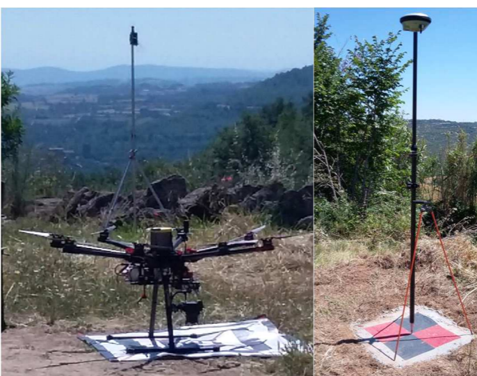
Col·locació de punts de control mitjançant GPS d'alta precisió per a l'ortorectificació d'imatges de drons.
