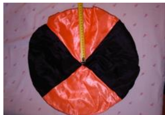
Figura 7. Mesura del radi de l'àrea de la secció transversal frontal exposada a l'aire del paracaigudes.
