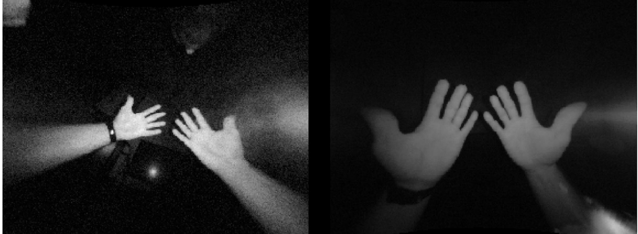
Joonis 6.2. Vaated Leap Motion kontrolleri kaamerast kui seade on paigaldatud kasutaja rinnale (vasakul) ja kui seade on kinnitatud OSVRi külge.
