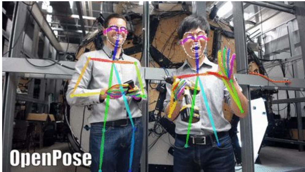
Joonis 3.11. Inimeste tuvastamine kasutades veebikaamerat ja OpenPose'i [39].
