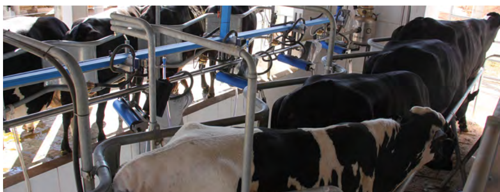
Figura 3. Sala de ordenha (contenção espinha de peixe, linha média de vácuo para 04 conjuntos, módulos de controle para avaliação de produção individual, extrator automático, módulo de limpeza automático).
