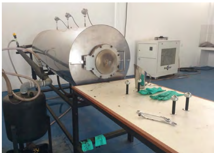
Figura 5. Reator de pirólise localizado na Embrapa Agrossilvipastoril.
