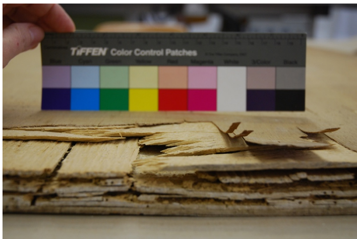
Figura 4. Visió lateral d'un dels suports. S'observen la laminació del contraplacat i la pèrdua de material constituït en diferents estrats. També s'observa la cola de melamina-formaldehid entre les capes de fullola. Fotografia d'Anna Nualart.
