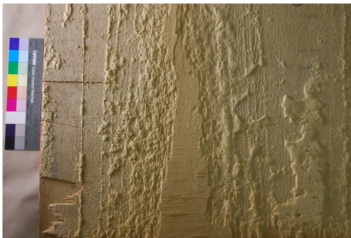
Figura 5. Aspecte de la cola de melamina-formaldehid del revers de l'obra amb número d'inventari H3077. S'ha produït la pèrdua de part de les capes de fullola del contraplacat i el revers mostra, actualment, tota la superfície amb les restes de cola deteriorada i restes de fusta aïllades que hi romanen adherides. Fotografia d'Anna Nualart.
