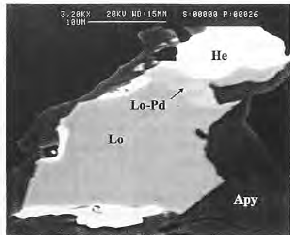
Figura 3.46. Gra de löllingita (Lo) reemplaçat per arsenopirita (Apy). A les vores presenta hessita (He) i löllingita pal·làdica (Lo-Pd). Imatge SEM-BSE.
