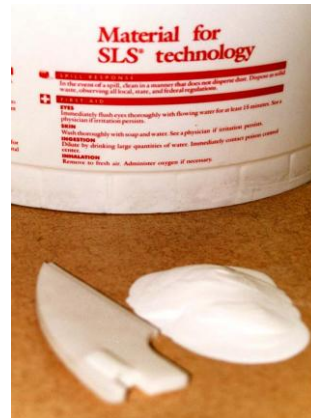
Foto 2: DuraForm Polyamide in poeievorm en vaste vorm
