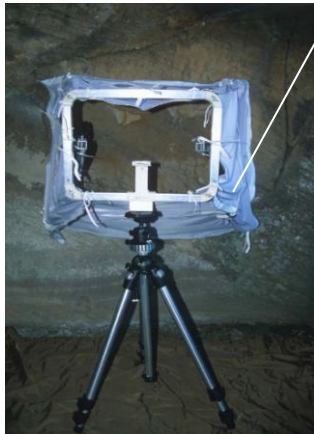
Foto 3.16: Eerste prototipe voor verbetering aan die tent ( verwys na toetsing 1: bl 50 )
