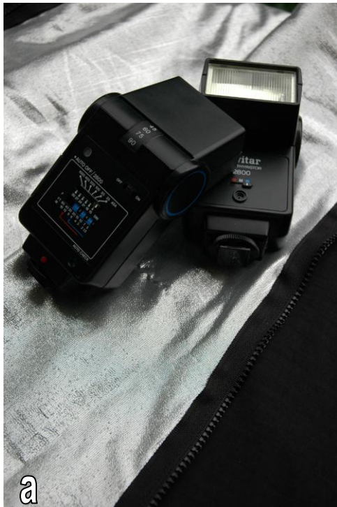
Foto 3.1: (a) Flitseenhede wat gebruik is tydens die Toetsings van die modulêre beligtingsinstrument veral tydens die dokumentasie van die rotsverfkuns.
