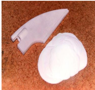
Foto 2: DuraForm Polyamide in poeievorm en vaste vorm
