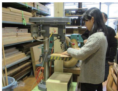
ボール盤で板に穴をあけている様子
