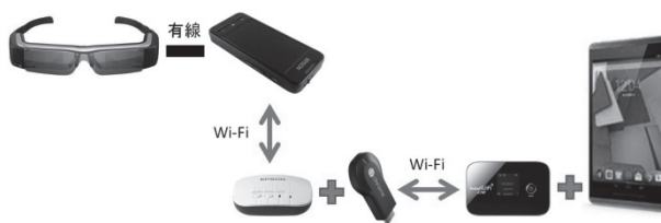
図 10 ChromeCast 追加後の実地投影装置のハードウェア接続図
