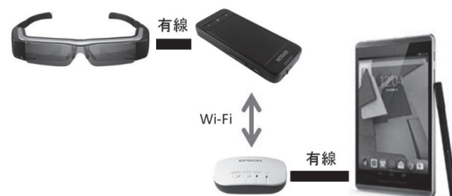
図 9 開発当初の実地投影装置のハードウェア接続図 (筆者作成)
