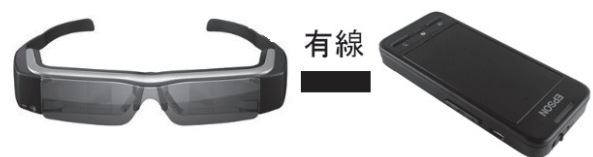
図 11 第二次改良後の実地投影装置のハードウェア接続図
