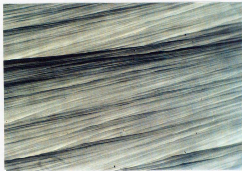
写真2-2 結晶イオウの偏光顕微鏡写真。この結晶は重合転移温度以下の温度から空冷して固めて得られたもので、 $\alpha$ -イオウである。
