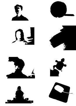
図 18 輝度の分散を評価し併合する分割併合法 Split-and-merge by merging with variance of intensity
