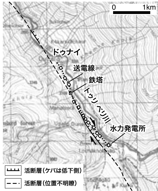
図5 ネパール北西部ドゥナイ (Dunai) 付近における水力発電所・送電線と活断層の位置関係位置は図1に示す。
