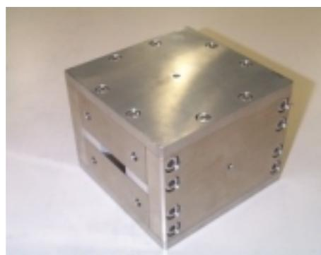
図4 4 . 2テスラ磁気回路
