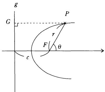
焦点  $F$  から準線  $g$  までの距離を  $c$  とし、円すい曲線上の点  $P$  の極座標を  $P(r, \theta)$ 、 $P$  から準線  $g$  へ下した垂線の足を  $G$  とすると、
