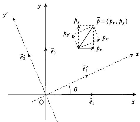
上の図において、基本ベクトル  $\vec{e}_1$ ,  $\vec{e}_2$  は新しい基本ベクトル  $\vec{e}'_1$ ,  $\vec{e}'_2$  を用いて、
