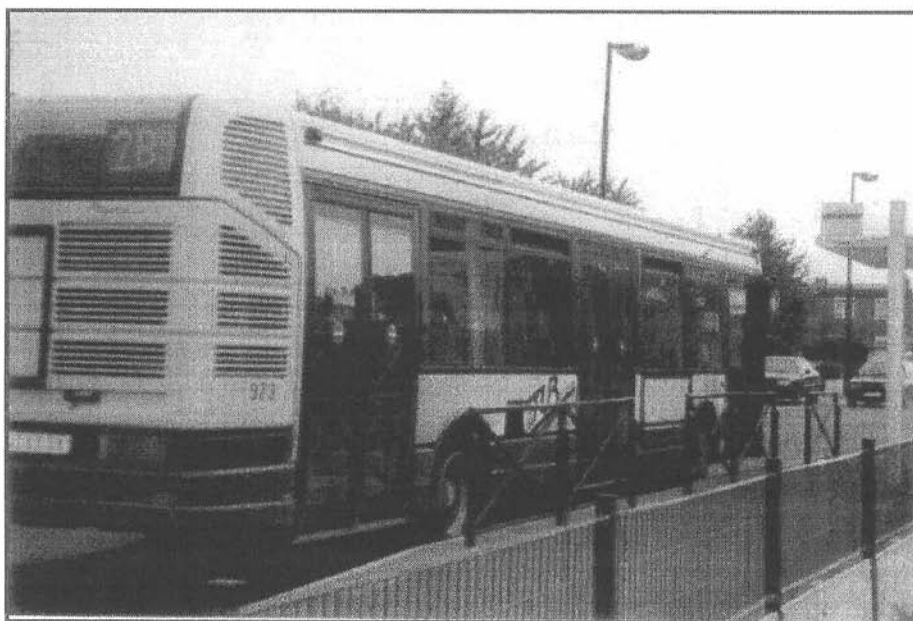
Arrêt Foyer Dechy (ligne 2) Arrêt rehaussé protégé par des barrières espacées au pas des portes du bus
