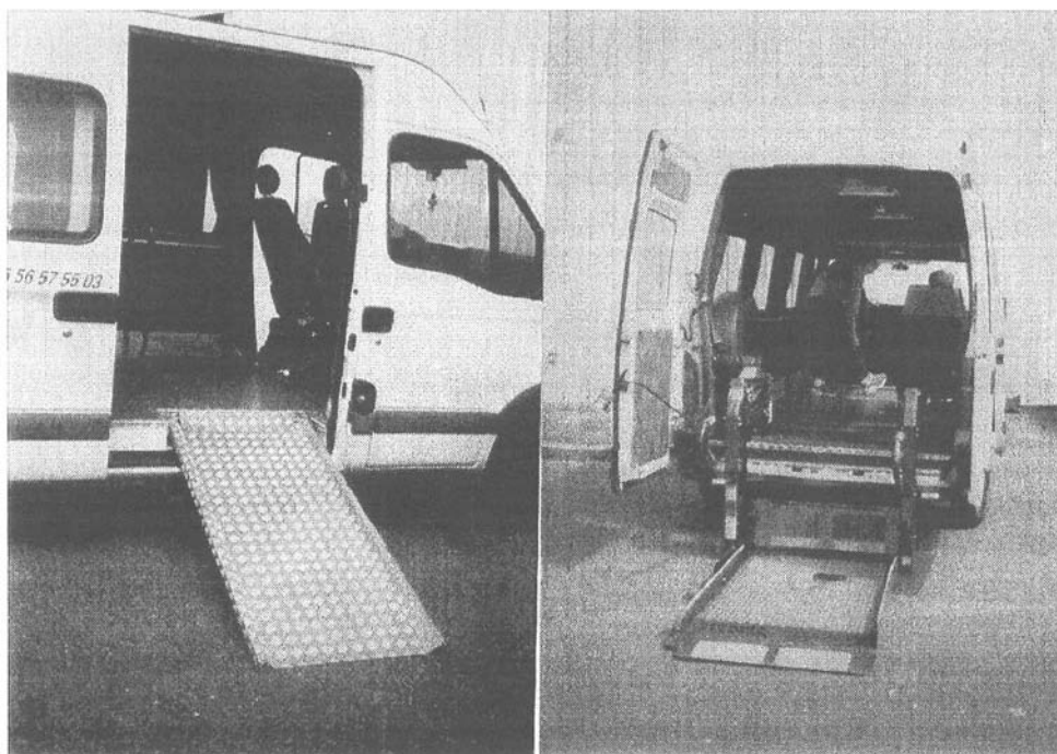
Le véhicule type de Transadapt sur base Renault Master, vues sur les deux palettes d'accès
