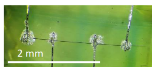
Slika 5.2.11: Fotografija uzorka Cd 3 As 2 frekvencije 15 T. Kontakti su na uzorak stavljeni srebrnom pastom. Debljina i širina uzorka su približno 5 \mu\text{m} .
