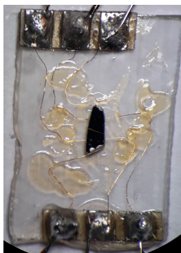
Slika 5.2.7: Fotografija uzorka Cd 3 As 2 frekvencije kvantnih oscilacija 43 T. Kontakti su napravljeni kontaktnim varenjem i srebrnom pastom.
