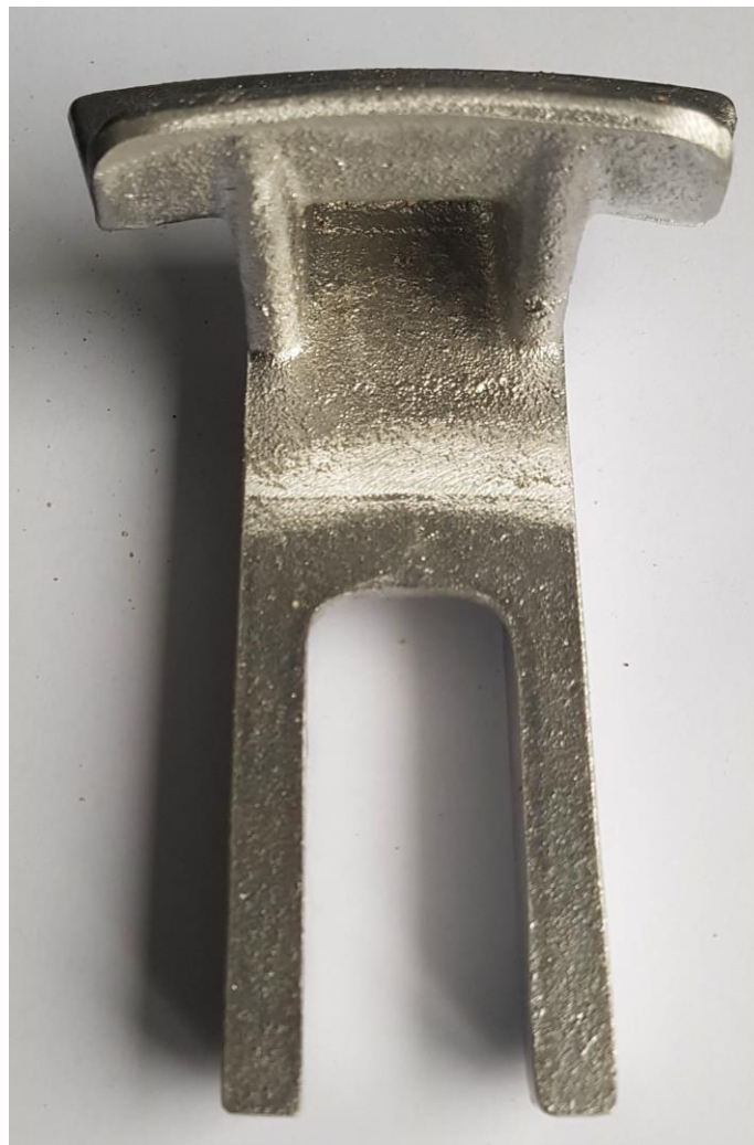
Slika 52. Odljevak nakon uklanjanja uljevnog sustava
