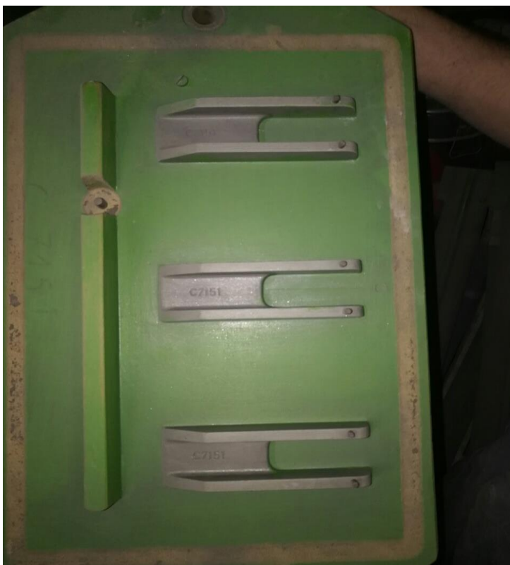
Slika 49. Modelna ploča za gornjak
