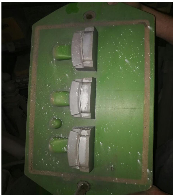
Slika 50. Modelna ploča za donjak
