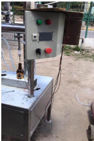
Figura 3.36. Montaje de tablero de control y componentes electrónicos
