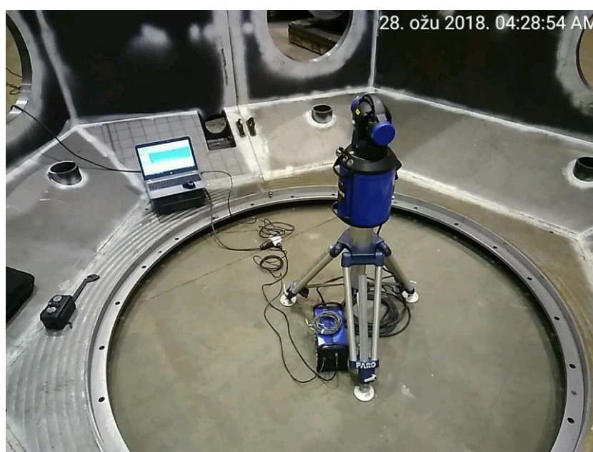
Slika 10 Prikaz trodimenzionalnog mjerenja laserskim uređajem „FARO Tracker“ [4]
