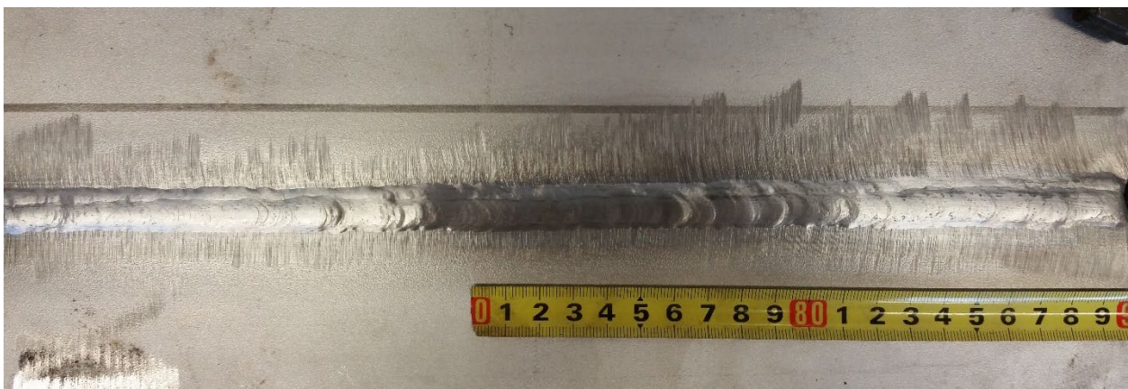
Slika 68. Prikaz trećeg prolaza popune nakon čišćenja oksida, Laboratorij za zavarivanje, FSB, Zagreb
