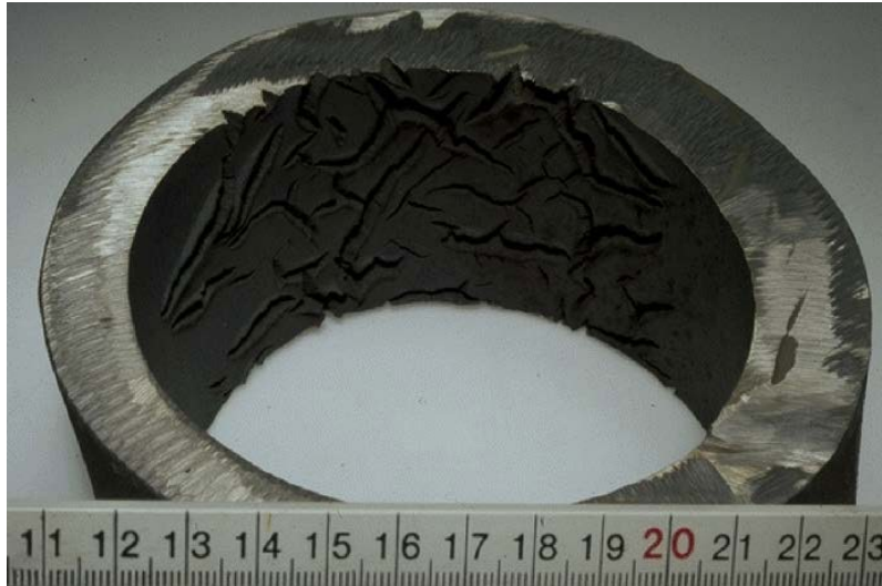
Slika 9. Prikaz karburiranja legure ASTM H P40 [19]
