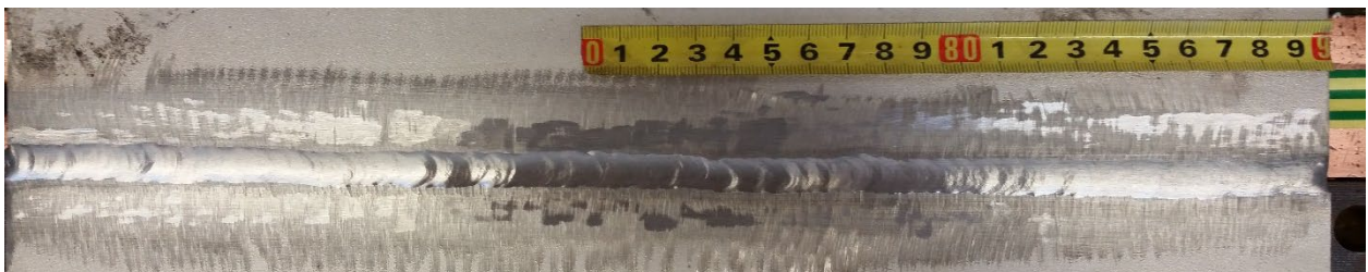
Slika 75. Prikaz popravka korijenskog prolaza nakon čišćenja oksida, Laboratorij za zavarivanje, FSB, Zagreb
