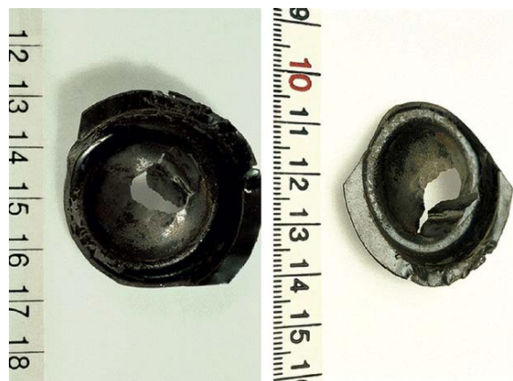
Slika 7. Prikaz napetosne korozije tehnički čistog nikla [19]
