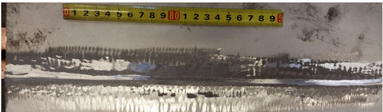
Slika 73. Prikaz korijenskog dijela zavarenog spoja nakon brušenja, Laboratorij za zavarivanje, FSB, Zagreb
