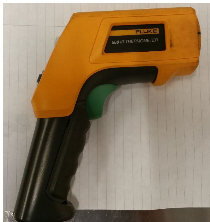
Slika 51. Prikaz uređaja za mjerenje temperature, Fluke 568, Laboratorij za zavarivanje, FSB, Zagreb
