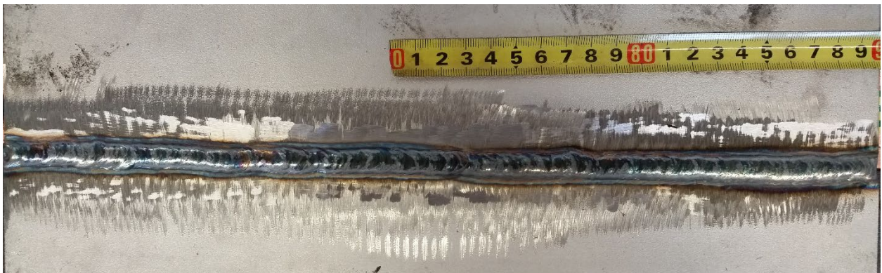
Slika 74. Prikaz popravka korijenskog prolaza nakon zavarivanja, Laboratorij za zavarivanje, FSB, Zagreb
