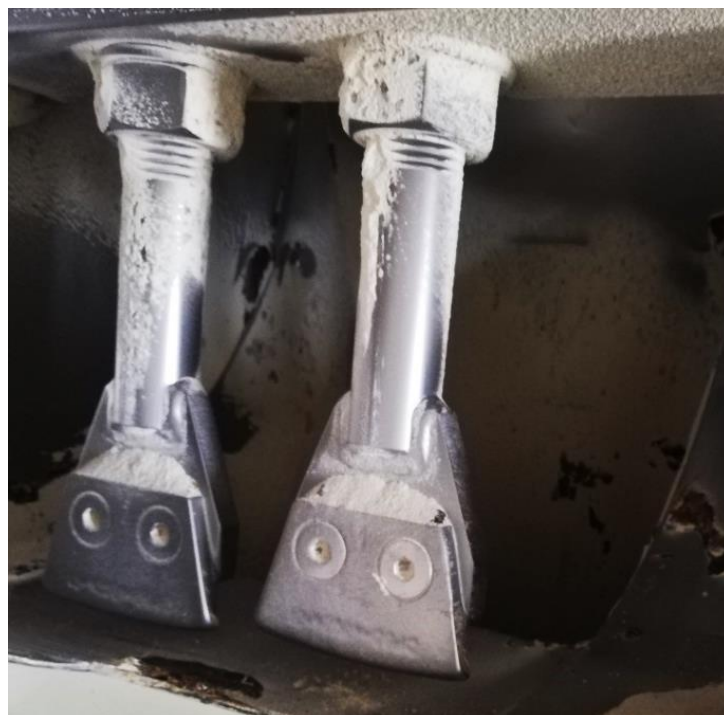
Slika 37. Lopatice na izlaznom otvoru homogenizatora (Fotografija: Janješić, 2019.)
