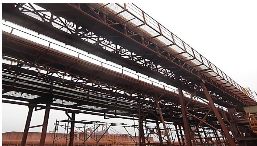
図 2.1 典型的なベルトコンベア設備
