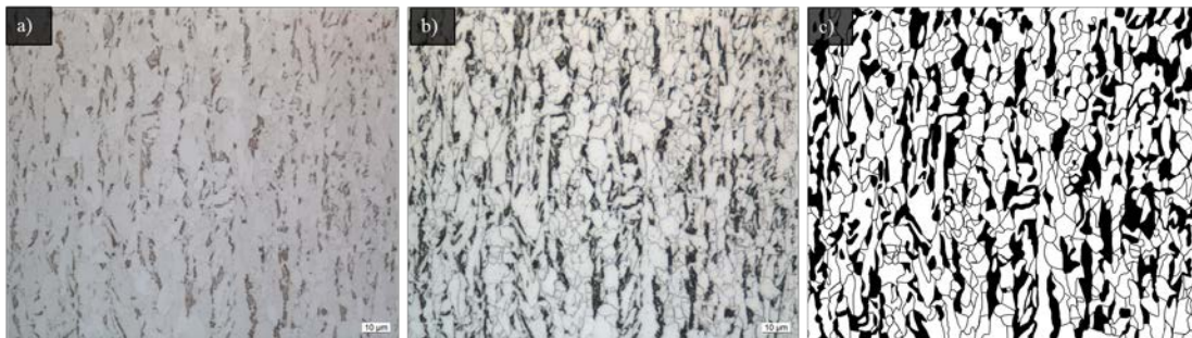
Abbildung 5-41: Kombination aus Beraha und Nital-Ätzung. a) Lini-Aufnahme nach der Beraha-Ätzung. Die Bereiche zweiter Phase sind deutlich erkennbar. b) Lini-Aufnahme der gleichen Stelle nach einer zusätzlichen Nital-Ätzung (35 s). Die Korngrenzen sind deutlich erkennbar, die zweite Phase erscheint dunkel aber deutlich größer als nach der Beraha-Ätzung. c) Ergebnis der Schwellwertsegmentierung zur Rekonstruktion der Korngrenzen.
