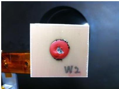
(d) Ring type RTV painted on the patch antenna
