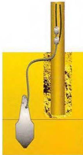
Figure 3. 3 L'électrode installée à proximité du poteau
