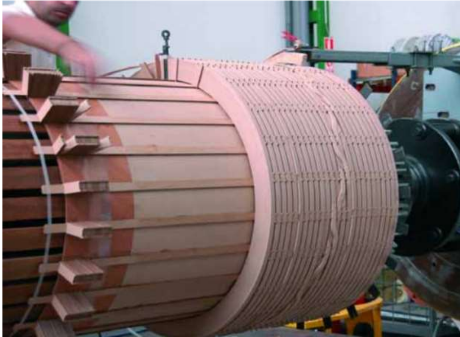
Ilustración 5. Construcción de un devanado tipo disco.
