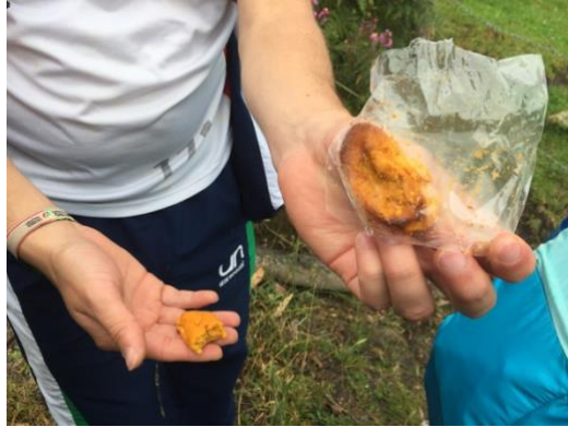
Figura 25. Deterioro del prototipo por aplastamiento y fricción. Fuente: elaboración propia.
