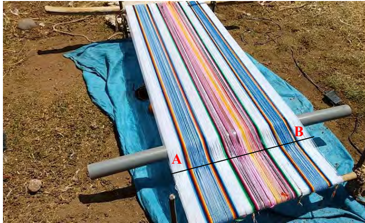
Figura 56. Tubo de PVC en el allwido y desplazamiento de segmento \overline{AB} de intersección
