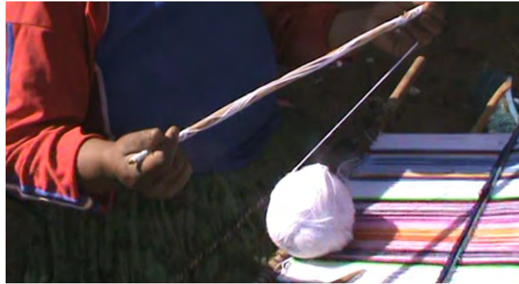
Figura 77. Construye la khespa que envuelve el mini o trama
