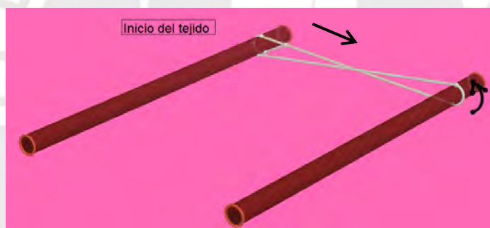
Figura 23. Allwido de las dos primeras urdimbres (una vuelta) en la pampa
