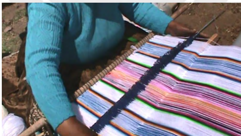
Figura 74. Con la ruka empuja el segundo cruce hacia el tocuro
