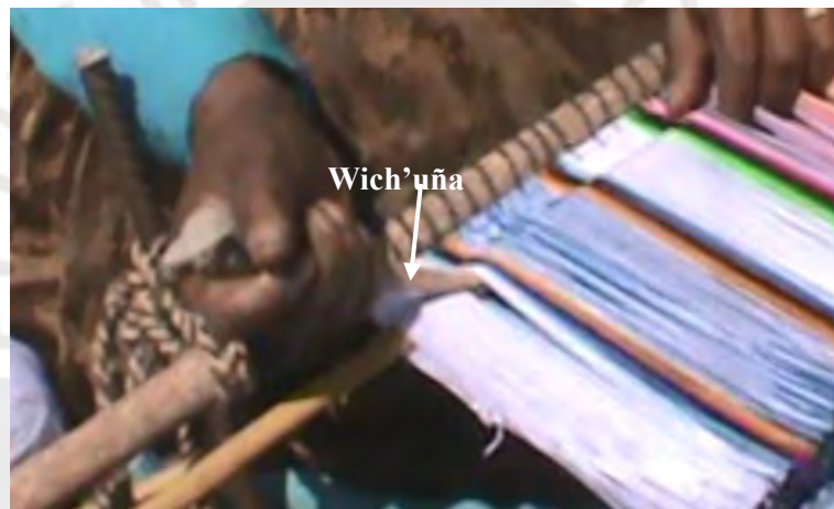
Figura 71. Prensa la trama con la wich'uña
