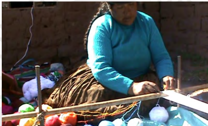
Figura 28. Fija las lanas entre las urdimbres y la awa. Los ovillos están junto a la tejedora
