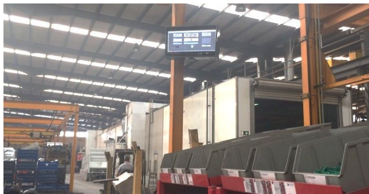
Figura 42 – Ecrã Andon na linha dos reboques de taipais
