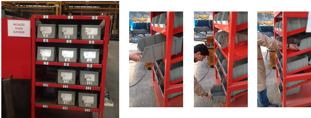
Figura 40 – Sistema de dupla caixa kanban na área de iniciação do chassi superior
