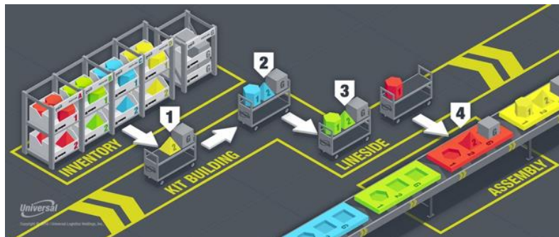
Figura 16 – Sistema de kitting in universallogistics.com , consultado em 2017-03-10, 19:25
