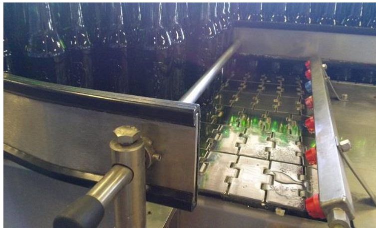
Figura 6 – Transportador com 6 pistas e bicos injetores de lubrificante
