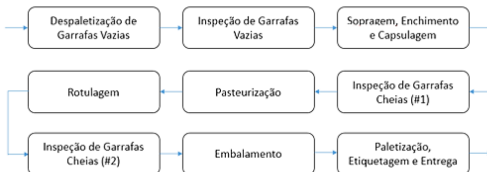
Figura 5 – Etapas do processo de enchimento de garrafas TP
