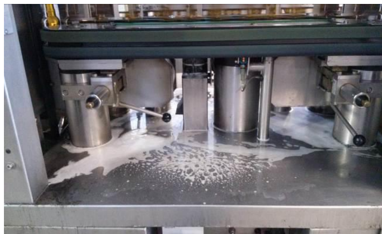
Figura 17 – Sujidade causada por lubrificação excessiva, no EBI #1 da linha 5
