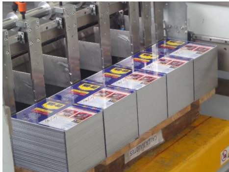
Figura 21- Corte secundário de corpos para embalagens de aerossóis
