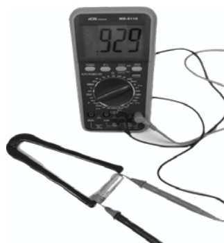
Figura 24 - Multímetro para observar a carga residual na bateria de Ni-MH
