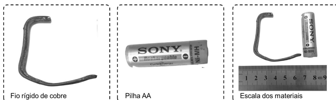
Figura 23 - Bateria de Ni-MH da marca Sony com fio rígido de cobre para desmantelamento
