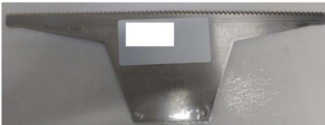
Figura 20 - Lâmina para embaladora em estado novo
