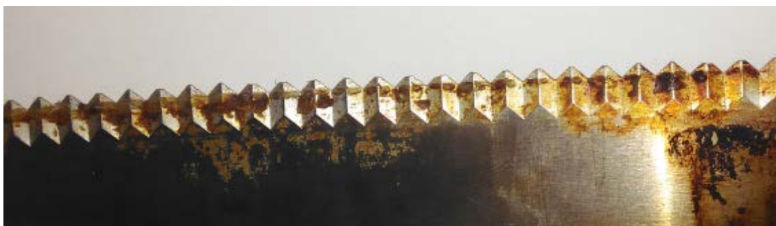
Figura 22 - Exemplificação de defeitos na lâmina da embaladora
