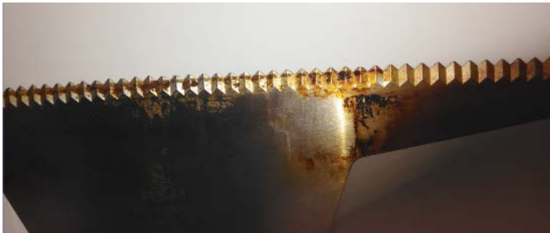
Figura 21 - Lâmina da embaladora já em elevado estado de degradação
