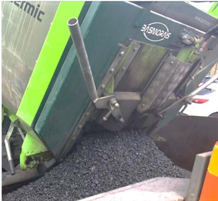
Figura 138 – Contentor a descarregar asfalto para máquina pavimentadora (vista traseira aproximada)
