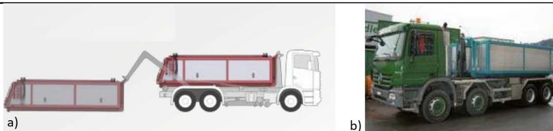
Figura 40 - Contentor para sistema Poli-basculante (Ampliroll ou Hooklift) a) esquema e b) exemplo
