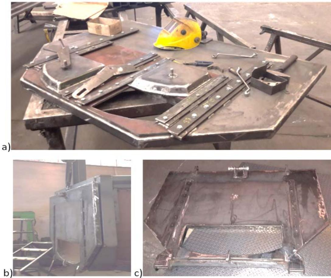
Figura 117 - Montagem da porta traseira a) montagem do avental com portinholas, b) montagem das dobradiças no contentor e c) aspecto da porta finalizada
