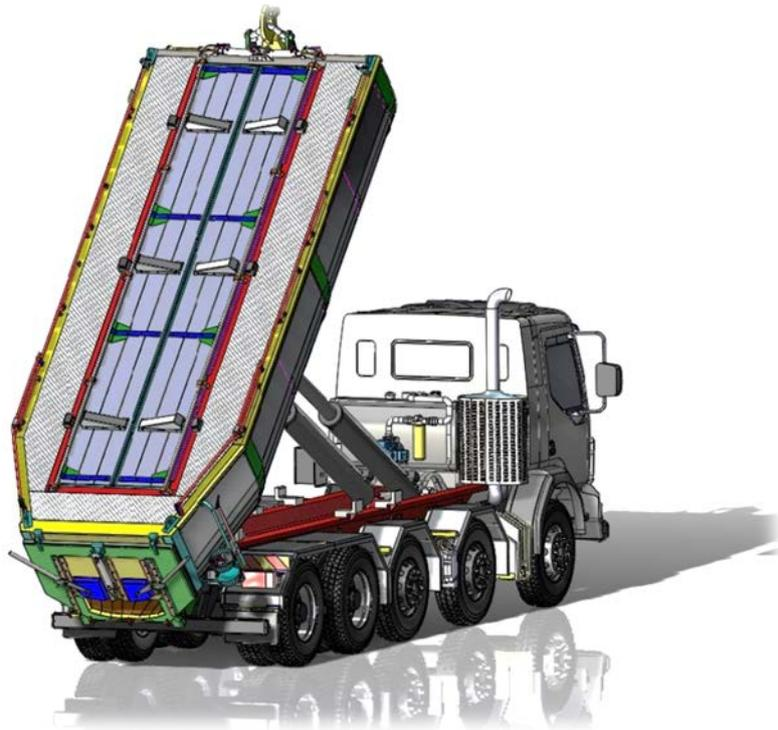
Figura 86 - Vista em perspectiva traseira do projeto final do contentor térmico redondo em modo de basculamento no equipamento *Ampliroll* (autoria própria)
