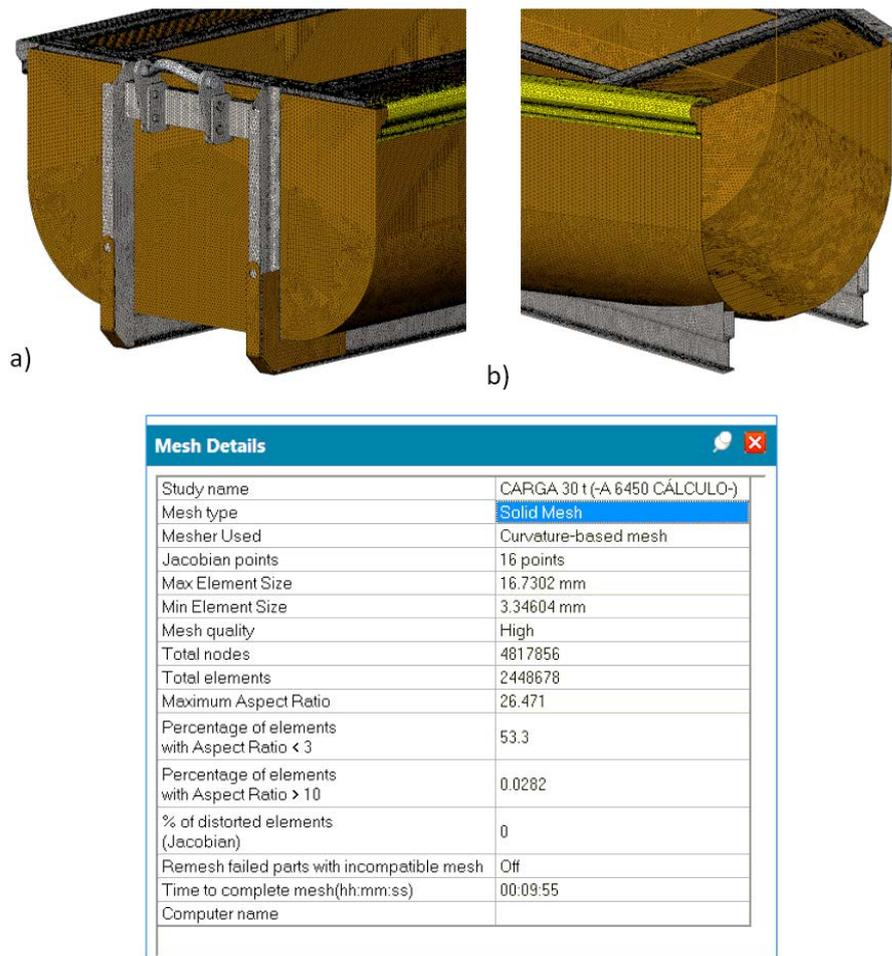
Figura 102 - Malha realizada para análise MEF no contentor a) vista frontal e b) vista traseira
