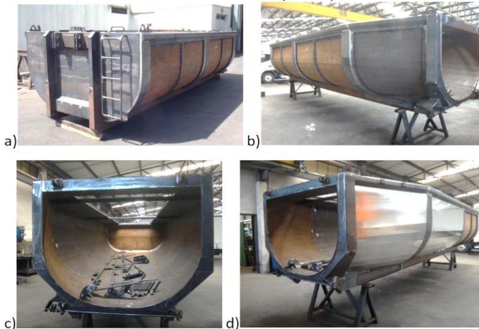
Figura 124 - Aspeto do contentor após montagem a) vista frontal, b) vista lateral, c) vista traseira e d) ensaio da forra de alumínio
