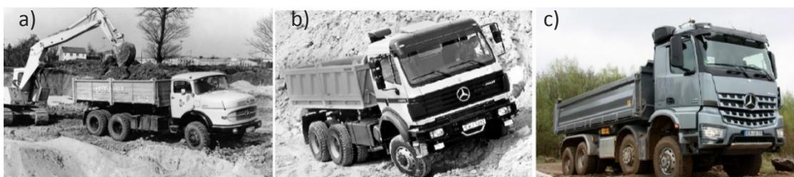
Figura 7 - Exemplo da evolução de veículos pesados de mercadorias, a) L1111, b) Actros e c) Arocs [19]
