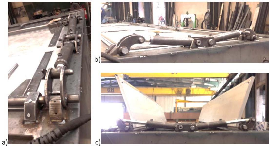
Figura 120 - Montagem do sistema de abertura das portas do teto a) vista lateral da montagem dos cilindros, b) vista frontal da montagem e b) verificação da abertura do sistema montado
