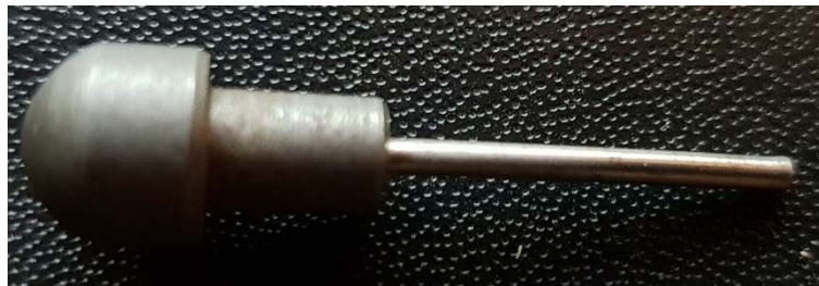
Figura 2.26. Punção utilizado para encravamento dos terminais
