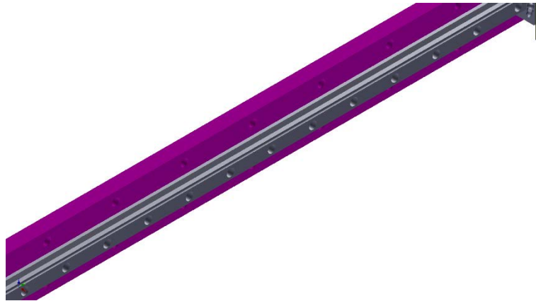
Figura 3.30. Furações que permitem o trancamento do sistema de afinação
