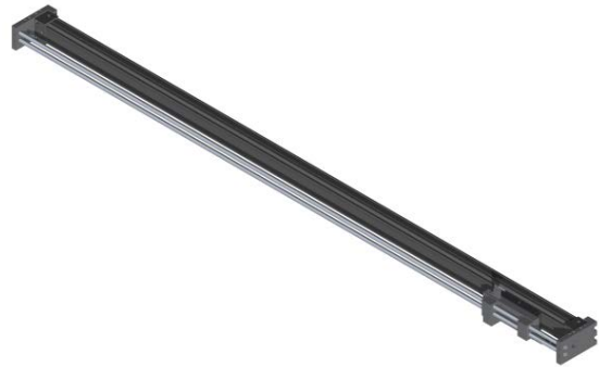
Figura 3.18. Mecanismo projetado para realizar o transporte da espiral
