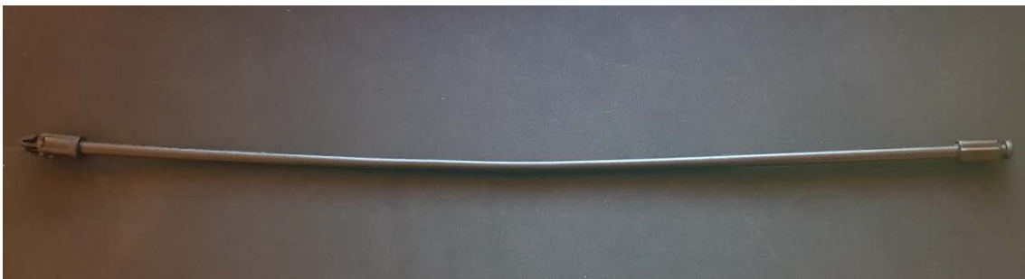
Figura 2.27. Tubo espiral já com ambos os terminais encravados
