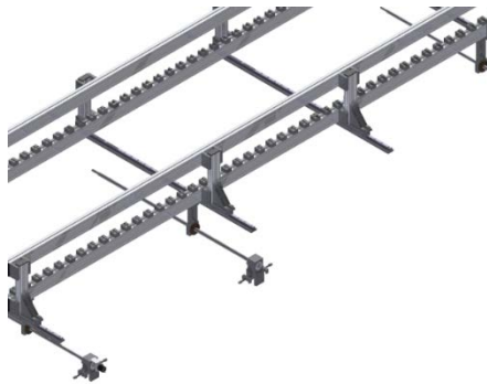
Figura 3.53. Conjunto que permite a afinação do comprimento da máquina
