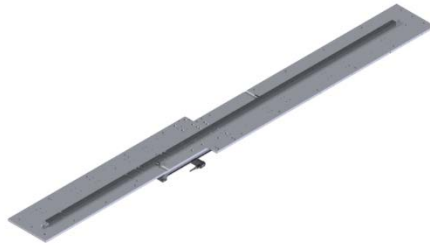
Figura 3.16. Transportador de espirais até à entrada da linha
