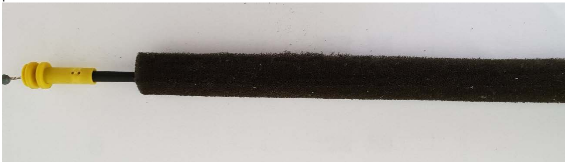
Figura 2.29. Tubo com uma camada exterior de tubo esponja para evitar os ruídos
