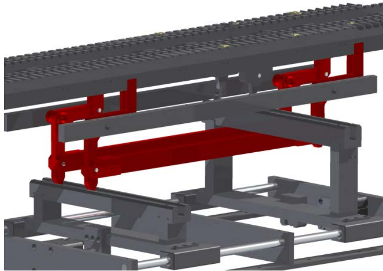
Figura 3.34. Alavancas que permitem levantar as espirais
