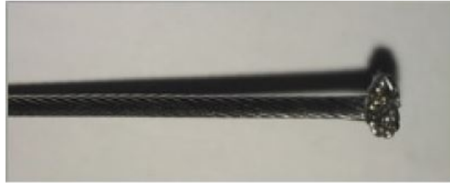
Figura 2.21. Cabo depois de efetuado a afloramento da ponta [34]
