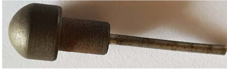
Figura 3.97. Ponteira que executa a punção dos terminais
