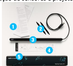
Figura 6.11 – Hardware Eye Tracker Tobii 4C constituído por 1. Documentação, 2. Suportes de montagem, 3. Tobii Eye Tracker 4C com cabo USB 2.0 de 80cm conectado, Guia de instalação e caixa (Retirado de (Tracker, 2017))
