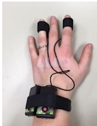
Figure 14 - Placement des capteurs sur la main gauche du participant
