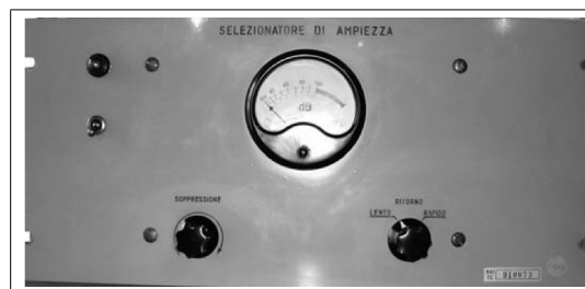
Figure 5. The front panel of the Selezionatore di ampiezza (photo courtesy of M. Novati [8]).
