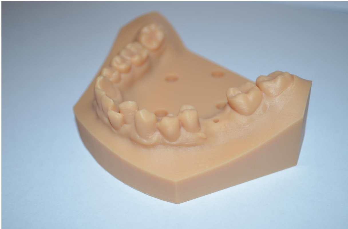
Abbildung 6: Final gedrucktes MExPERT IPM Kunststoffmodell mit vorabgeplanten Koordinationsbohrungen „K1, K2, M1, M2, BL“.
