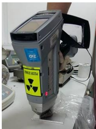
Slika 3.3.: Merjenje z rentgenskim fluorescenčnim spektrometrom
