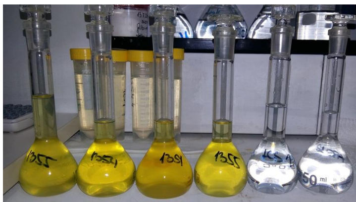
Slika 3.6.: Pripravljeni vzorci za ICP-OES
