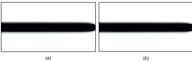
Figura 4. Viga en voladizo. Diseño óptimo robusto considerando incertidumbre en la magnitud de la carga. (a) MC, (b) MCK.
