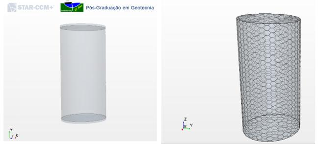
Figura 7. (a) Modelo geométrico do cilindro. (b) Modelo geométrico discretizado mediante o método *trimmed mesh*.
