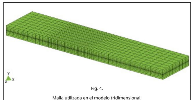
Para realizar la simulación numérica se han definido dos materiales distintos. Uno de ellos corresponde al material compuesto. El otro material definido (que denominaremos material inserto) corresponde a la lámina que se introduce en el compuesto para caracterizar la fractura inicial.
