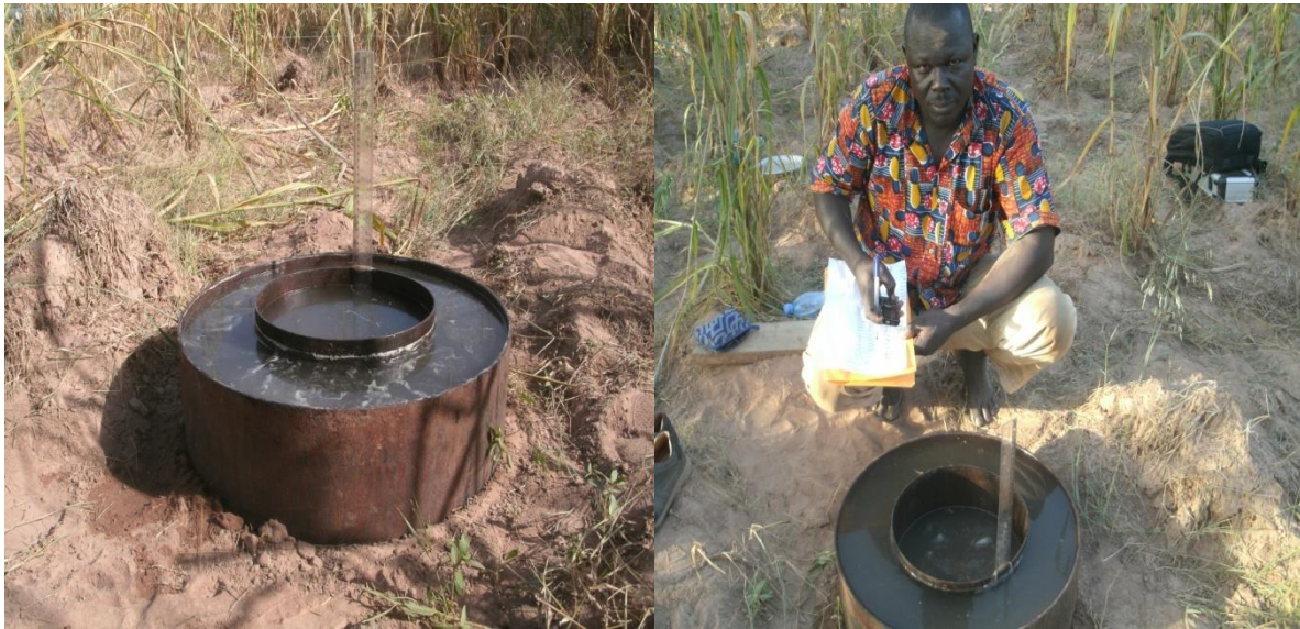
Figure : 4 Dispositif de mesure d'infiltration Figure : 5 séance de lecture pour mesure d'infiltration
