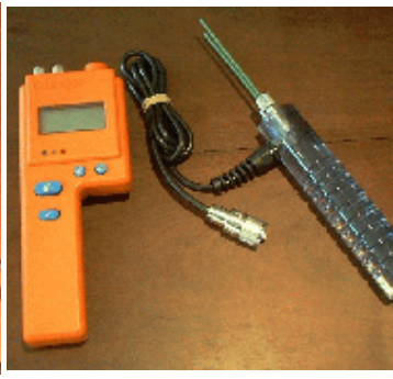
Medidor de humedad en paramentos
